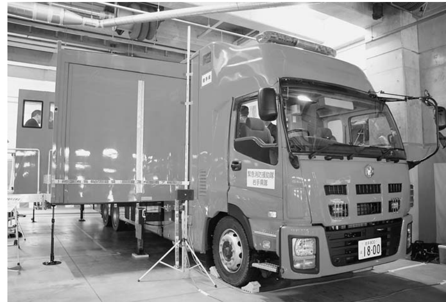
◀緊急消防援助隊拠点機能形成車両 全長約12m×全幅約2.5m×全高約3.6m。 車両荷室部分がせり出し約40㎡の空間を確保することができる
