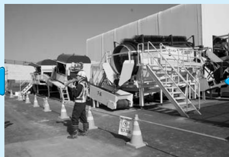
回転式選別機。破碎したのがれきをさらに選別機にかけます
