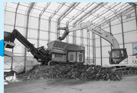
破碎機。木材などはここで一定の大きさに破碎
