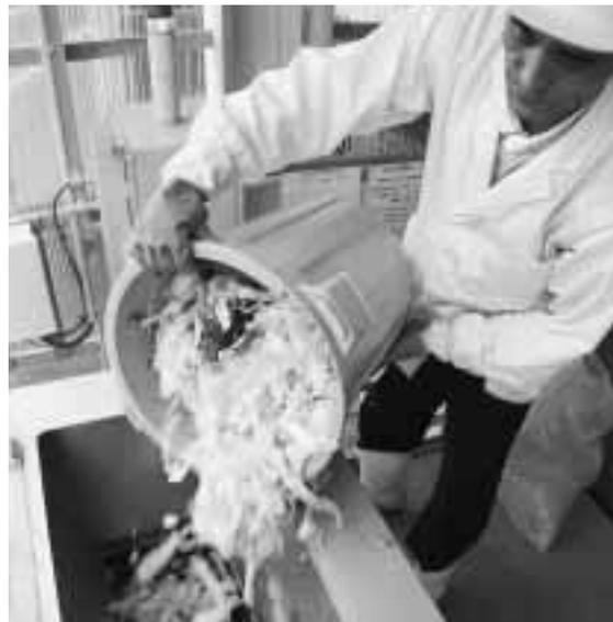
生ごみを投入口から入れ、適量の水と菌床材のものがらなどを補充するだけで、あとはかき混ぜたり、排水まで機械が自動で行ってくれます
