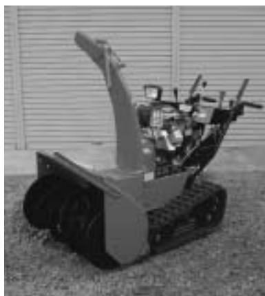
【小型除雪機的主要仕様】 出力：10.5馬力 除雪幅：800mm 除雪能力：60 t / 時
