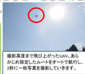
撮影高度まで飛び上がったUAV。あらかじめ設定したルートをオートで飛行し、2秒に一枚写真を撮影していきます。
