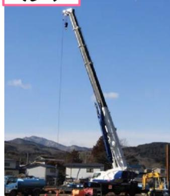
重い資材を吊り上げる、建設現場ではおなじみの重機です。「〇〇トンクレーン」の〇〇トンは、吊り上げ可能な重量を表しています。当現場では現在まで25~220トンのクレーンを使用しています。車輪付きで公道を走行できるタイプはラフタークレーン、キャタピラ付きで現場内のみ走行できるタイプをクローラクレーンと呼びます。(写真は25トンラフタークレーン)
