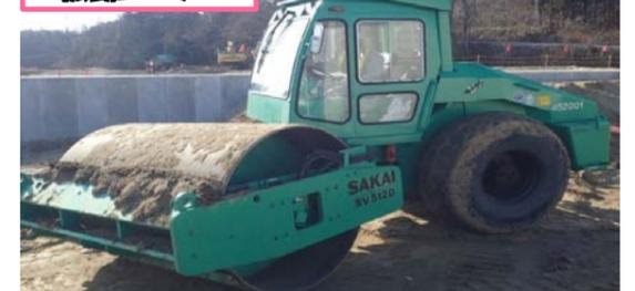
振動ローラーは土砂を転圧(てんあつ)する重機です。土砂に圧力をかけて均すことで、砂ぼこりが発生しづらく、人や車両が通行しやすい平らで固い路面をつくります。
